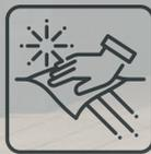
Las superficies barnizadas con los productos de las series **AOX e OPX** se reparan frotándoles ligeramente con un paño húmedo o mojado con agua caliente. La película **OPX** también se puede reparar calentando la superficie dañada con un secador de pelo durante 30 s y luego frotando con un paño húmedo. Para una protección adicional de la película **VMAOX** y para una recuperación eficaz de la misma se recomienda dar una mano de acabados de la serie **AOX**.
