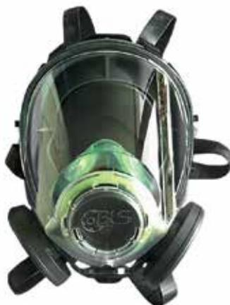
Maschera pieno-facciale in gomma termoplastica con certificazione FDA (BLS 5500). Visore in policarbonato testato in classe ottica 1 (EN 166). Trattamento antigraffio. Valvola di espirazione con copertura anti-schizzo.
