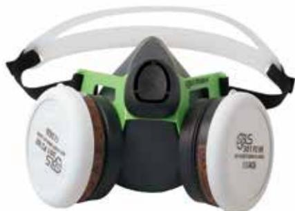
Respiratore oronasale a semimaschera in gomma termoplastica completo di filtri 019SA2R01 e 019SP2R01 per la protezione da gas, vapori organici e polveri. Classe di protezione A2, EN 14387:2004. Marcatura CE.
